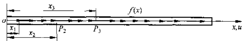
图 9.2 受轴向载荷作用的等截面直杆
